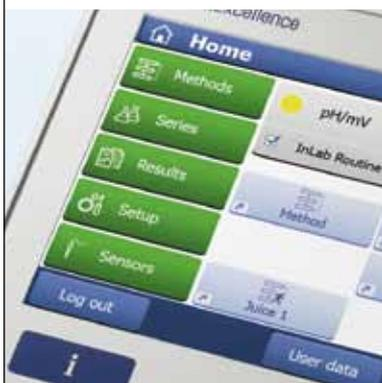
Un simple clic sur un raccourci suffit pour lancer une série ou une méthode. Si le lancement est demandé en cours d'exécution, la prochaine analyse sera placée dans la file d'attente de la liste des tâches et commencera automatiquement dès la fin de la tâche précédente.
