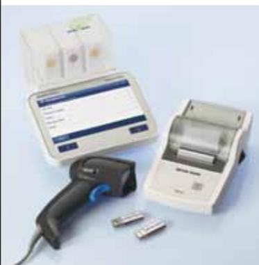
Grâce à ses interfaces USB, Ethernet et RS232, le SevenExcellence peut être connecté à un lecteur de code barres, un passeur d'échantillons Rondolino, une clé USB, des imprimantes METTLER TOLEDO, le réseau et un ordinateur utilisant le logiciel LabX® direct.
