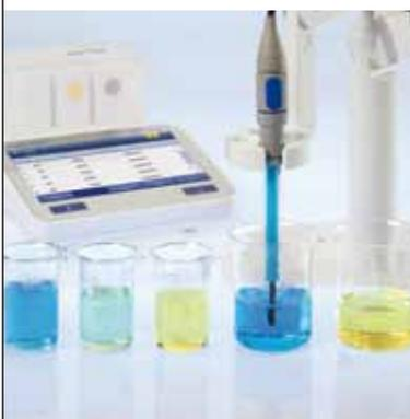
La fonction Series permet d'analyser plusieurs échantillons avec la même méthode directement l'un après l'autre. Non seulement l'efficacité de l'analyse est améliorée, mais des données statistiques, comme la moyenne et l'écart type des échantillons, sont générées automatiquement.
