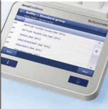
Choisissez parmi l'un des huit ensembles de tampons d'étalonnage prédéfinis ou créez facilement votre propre ensemble. La fonction Pick-and-Mix™ permet d'associer aisément des tampons pH issus de différents ensembles. À l'issue de l'étalonnage, l'icône de capteur permet de voir d'un coup d'œil la qualité de l'étalonnage.
