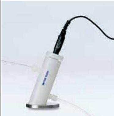
Mesurer de faibles conductivités demande une attention particulière. Avec l'eau pure ou ultra-pure, différents facteurs peuvent fausser les mesures, comme le dioxyde de carbone de l'air et une température inexacte. Avec sa précision de température élevée et sa cellule à circulation en option, notre cellule de conductivité numérique Inlab® Trace offre la solution idéale.
