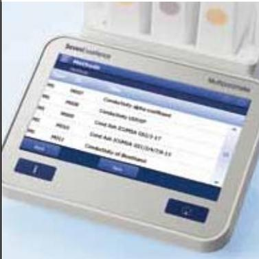
En plus d'être plus sûres, plus reproductibles et plus commodes grâce à leurs paramètres identiques, les méthodes vous permettent aussi d'exécuter des applications spéciales pour mesurer la conductivité. Cela comprend les mesures USP/EP de l'eau pure avec surveillance des limites et les mesures de cendres conductimétriques selon deux réglementations ICUMSA.
