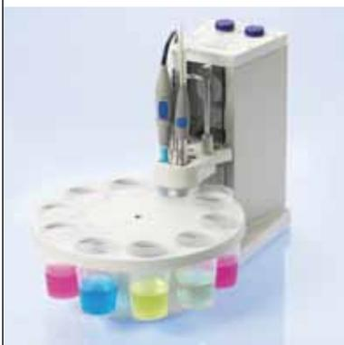
SevenExcellence est compatible avec le passeur d'échantillons Rondolino pour les méthodes et les séries, ce qui permet de réaliser des analyses automatiques sans assistance. Non seulement cela vous donne la possibilité de vous concentrer sur d'autres tâches, mais cela autorise également des applications particulières comme l'étalonnage automatique du pH.
