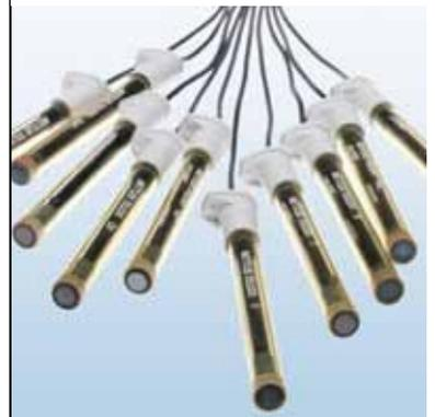
Avec SevenExcellence, il est possible d'utiliser notre gamme perfectION™ d'électrodes ioniques sélectives combinées ainsi que notre gamme de demi-cellules. Pour les mesures effectuées avec des capteurs à demi-cellule, une électrode de référence est nécessaire.
