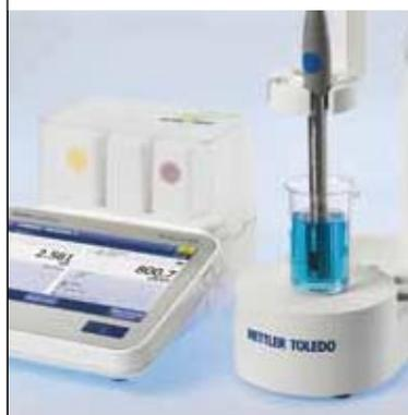
L'agitateur magnétique en option uMix™ de METTLER TOLEDO apporte une souplesse supplémentaire aux méthodes. Il est possible de configurer individuellement l'agitation pour les étapes de mesure ou d'attente de la méthode et de régler la vitesse d'agitation en fonction de la taille du récipient et de la viscosité de l'échantillon.
