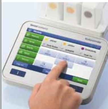
Un simple clic sur un raccourci vous permet de lancer une méthode : une séquence d'étapes d'analyse avec des paramètres prédéfinis fixes. Les méthodes vous garantissent qu'une analyse donnée soit toujours effectuée en utilisant des paramètres identiques.
